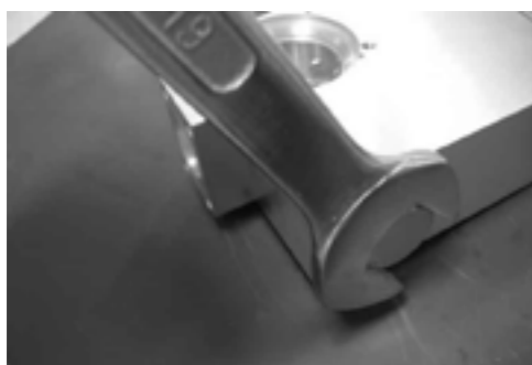
图 3-12 松动堵头螺钉
