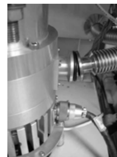
图 3-18 分子泵前级口放气
